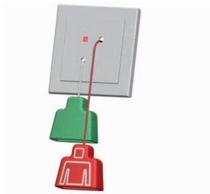
Zugtaster mit 2 m langer Zugschnur mit rotem Knauf mit Pflegedienstsymbol und Rufabstellung über weiße 80 cm lange Zugschnur mit grünem Knauf
