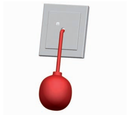
Pneumatischer Ruftaster mit pneumatischem Schaltelement. Auslösung durch Druck auf roten Gummiball an 2 m langem Klarsicht-Kunststoffschlauch
