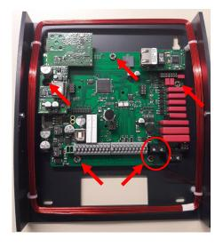
Klemmen Sie die interne Spule ab und biegen Sie die beiden Anschlussdrähte zur Seite. Lösen Sie die fünf Befestigungsschrauben und entnehmen Sie die Platine.
