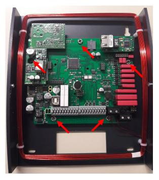
Legen Sie nun die Platine ein und befestigen Sie Adapter und Platine mit den fünf Schrauben.
