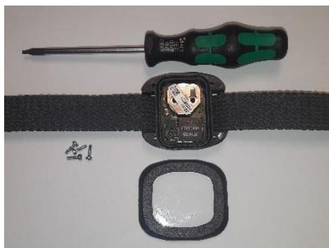
3. Leiterplatte herausnehmen und mit dem Ausdrückwerkzeug (hier im Bild mit einem Zahnholz) die Batterie herausschieben.
